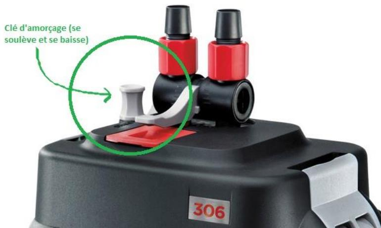
Vous allez entendre de l'eau couler et commencer à remplir le filtre. Ramener la clé d'amorçage à sa position vers le bas. Des bulles devraient ressortir à l'autre extrémité dans l'aquarium. Lorsqu'il n'y a plus de bulle, allumez le refroidisseur et branchez le filtreur, le système devrait démarrer par lui-même.
