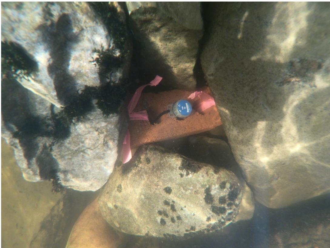
**Figure 15** Thermographe installé entre des roches sur la rivière Malbaie (FQSA, 2020)
