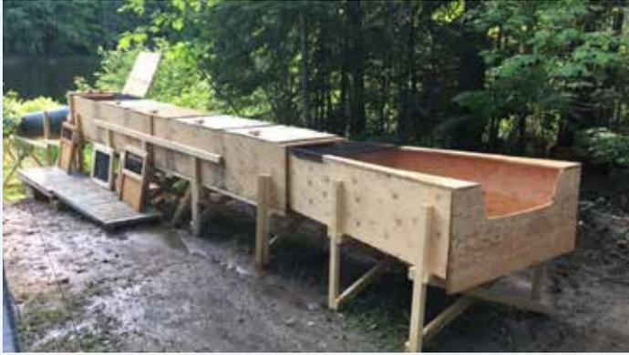
**Figure 4 :** Dispositif élaboré par le personnel de la zec de la rivière Rimouski pour échantillonner les saumons en montaison
